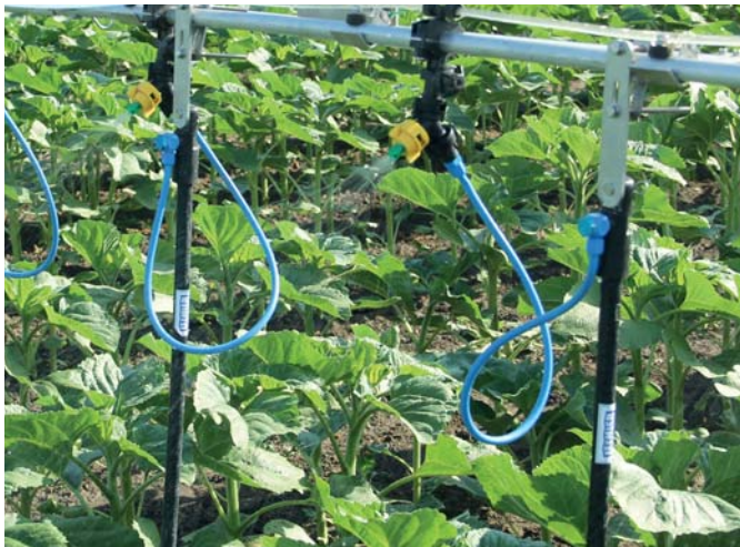
Работа форсунок на штанге опрыскивателя в комбинации с Dropleg UL
