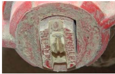
"Закоксованный" распылитель — опрыскиватель не промыли после обработки фунгицидом
