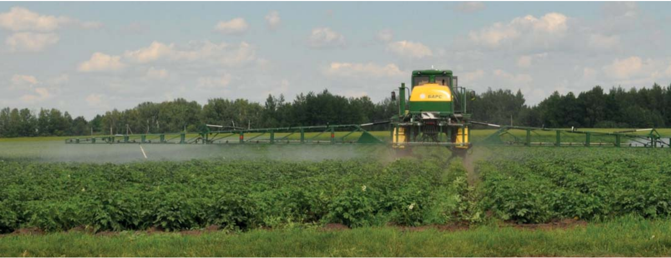
Снос при использовании разных типов форсунок. Слева на штанге щелевые форсунки ST со сном, справа инжекторные IDKT без сноса рабочего раствора
