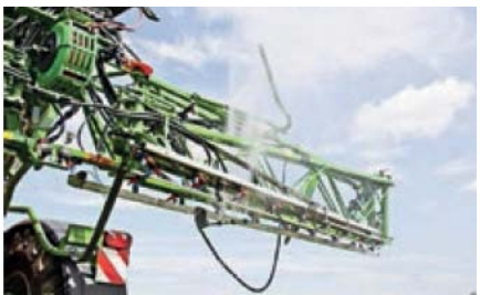
Автоматическая промывка штанги снаружи
